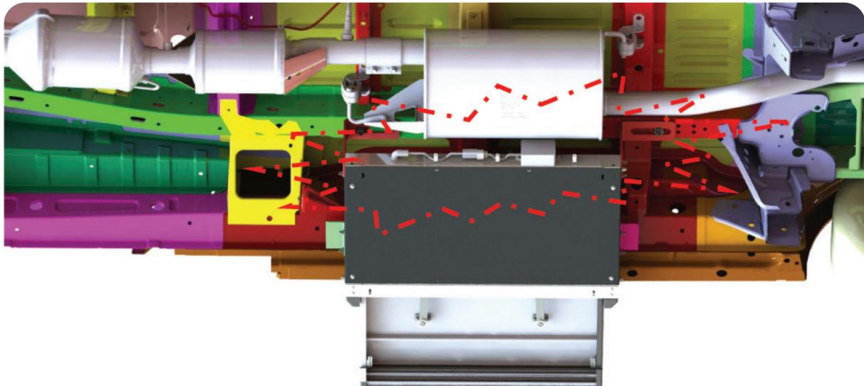
Vor der Montage am Fahrzeug sollte das Steuergerät auf die Oberseite der Trittstufe verlegt und befestigt werden!
